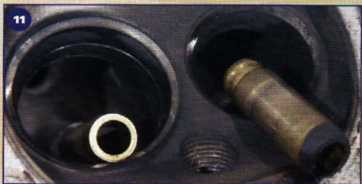
Die Ventilführungen (meist aus Messing oder Bronze) werden per Hydraulikpresse ausgepreßt
