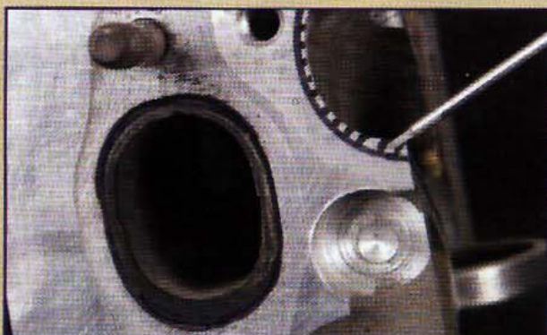
8 Hier darf gebohrt werden, aber Achtung auf die Wandstärke
