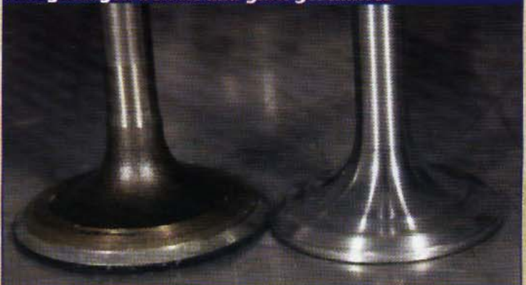
An einer Spezialschleifmaschine wird das Ventil von Ablagerungen befreit und glatt geschliffen
