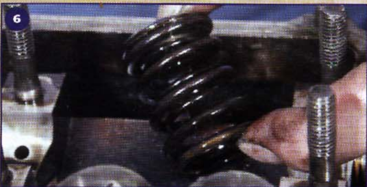
6 Die „freigelegte“ Ventilfeeder
