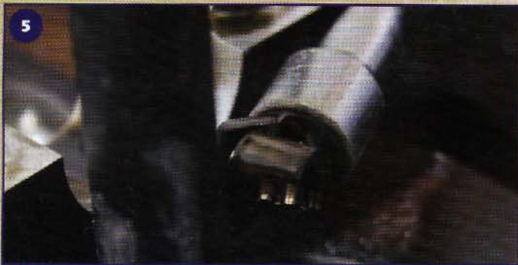
5 Die zwei Haltekeile des Ventilschafts entfernt man am besten mit einem Magneten
