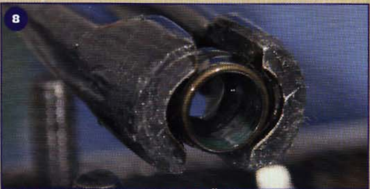
8 Mit einer Spezialzange wird die Ölabschirmkappe von den Ventilsitzen gezogen
