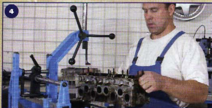
4 Mit dem „Ventilknecht“ wird jede einzelne Feder vorgespannt
