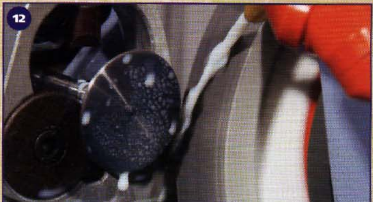
An einer Spezialschleifmaschine wird das Ventil von Ablagerungen befreit und glatt geschliffen
