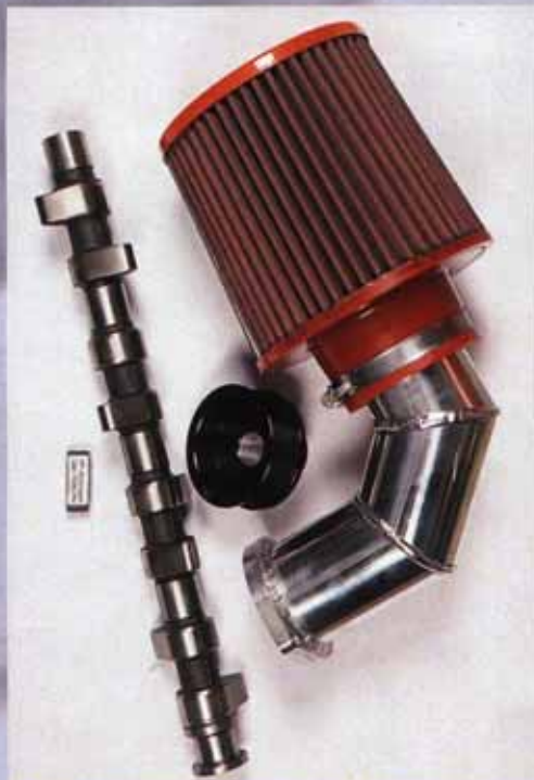
Kleines Laderrad, „scharfe“ Nockenwelle und „Chip“ pushen die Leistung
